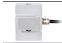
K25 Kraftmessdose (Nur DK660-3DMS) Zur Messung von Druck-/Zugkräften Messbereich: 0,02 bis 50 KN Genauigkeitsklasse: 0,1%/0,2%
