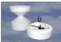
ARG100 Regenmesser preisgünstiger Regenmesser nach dem Kippwaagen-Prinzip Auffangfläche: 506,7cm 2 Empfindlichkeit: 0,2mm
