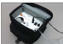
O-Punkt-Kalibrator eignet sich besonders, wenn viele Geräte kalibriert werden sollen. Bestehend aus Pumpe, Chemikalien, Tragetasche, Netzteil
