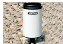
Young 52202/52203 Regenmesser Beheizbar, Kippwaagen-Prinzip mit WMO Empfehlung Auffangfläche: 200cm 2 Auflösung: 0,1mm
