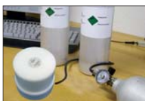
Kalibrierkit Zur Offsetkalibrierung des DK660 bestehend aus Kalibriergas 400ppm, Regulator und Kalibrieradapter
