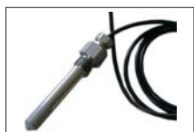
DKRF370-325 - Feuchte-/Temperaturfühler für Druckluft bis 100bar, G3/8" Gewinde, L=100mm, D=13mm, Einsatz bei -20...+80°C.
