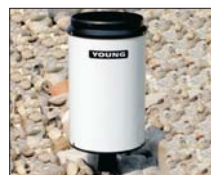
Young 52202/52203 Regenmesser Beheizbar, Kippwaagen-Prinzip mit WMO Empfehlung Auffangfläche: 200cm 2 Auflösung: 0,1mm
