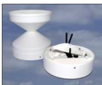
ARG100 Regenmesser preisgünstiger Regenmesser nach dem Kippwaagen-Prinzip Auffangfläche: 506,7cm 2 Empfindlichkeit: 0,2mm
