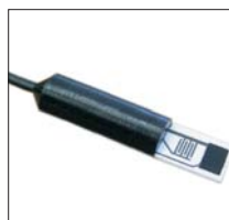
SHSW-325 - Spezialfühler zur Detektion von Benetzung bzw. Wassereintritt. Wasserschalter liefert Signal 1, wenn Wasser detektiert wird und 0 wenn der Sensorbereich trocken ist. Abmessungen: 60 x 10mm
