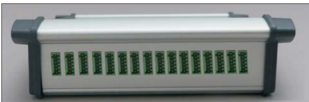
Anschluss von bis zu 16 Sensoren und Messwertgebern
