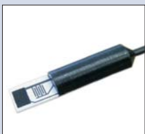
SHS - Spezialfühler zur Messung einsetzender Betauung. Kondensationsensor liefert Signal 1, wenn Benetzung mit Wasser in Folge von Kondensation auftritt. Abmessungen: 60 x 10mm Einsatz 0...50°C
