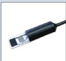
SHS - Spezialfühler zur Messung einsetzender Betauung. Kondensationsensor liefert Signal 1, wenn Benetzung mit Wasser in Folge von Kondensation auftritt. Abmessungen: 43 x 10mm Einsatz 0...50°C
