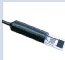
SHSW - Spezialfühler zur Detektion von Benetzung bzw. Wassereintritt. Wasserschalter liefert Signal 1, wenn Wasser detektiert wird und 0 wenn der Sensorbereich trocken ist. Abmessungen: 60 x 10mm
