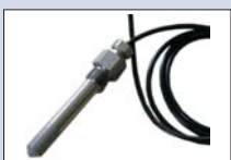
DKRF370 - Feuchte-/Temperaturfühler für Druckluft bis 100bar, G3/8" Gewinde, Abmessungen D=13mm x 100mm Einsatz bei -20...+80°C.
